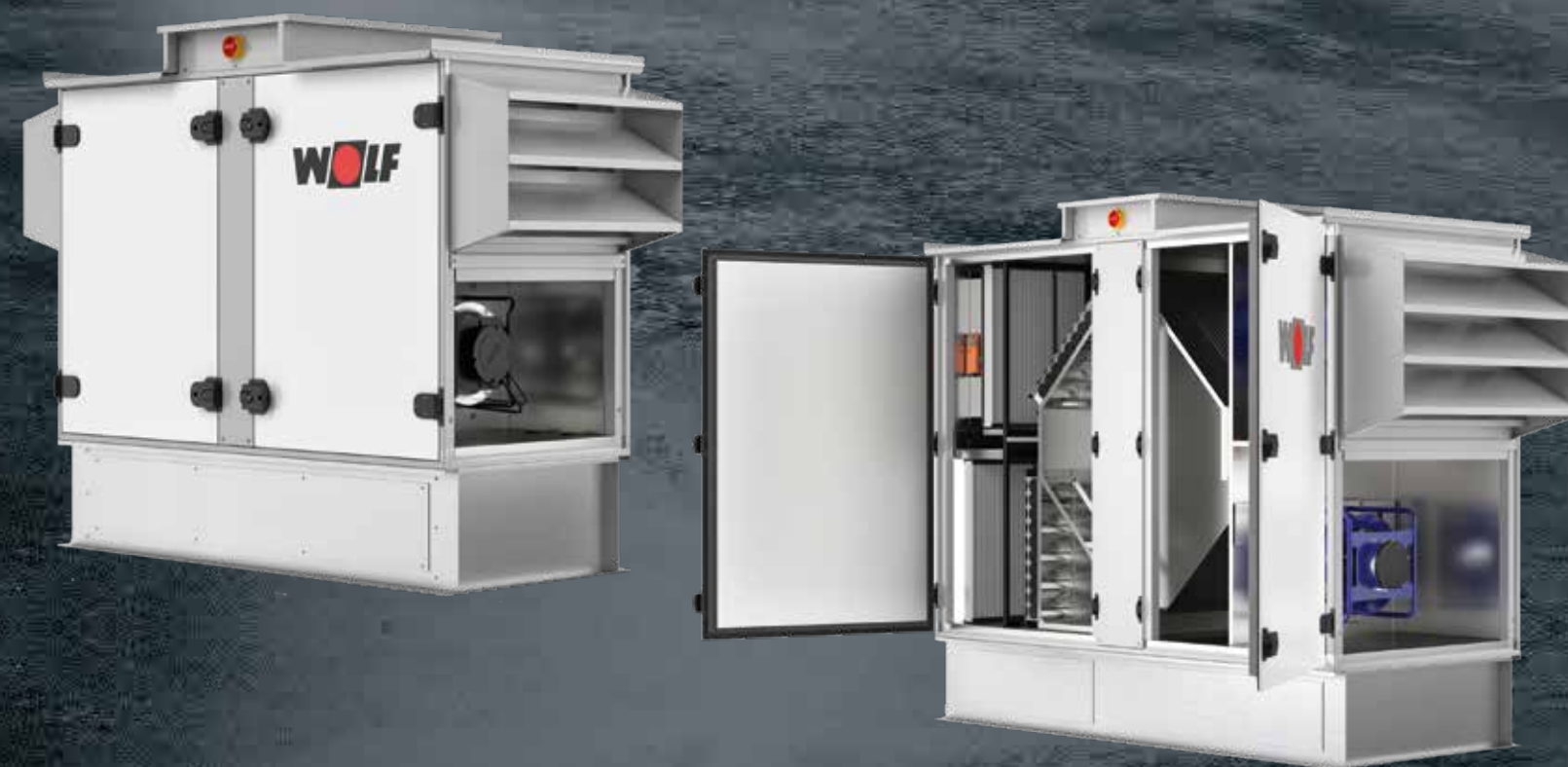
De CKL evo is een compacte, hoogrendement warmteterugwinunit voor de utiliteitsbouw. Het product betreft een doorontwikkeling van de bekende en gewaardeerde CKL en onderscheidt zich door een verbeterde ventilatorconfiguratie en een hogere isolatiewaarde ten aanzien van temperatuur, geluid en luchtdichtheid.
